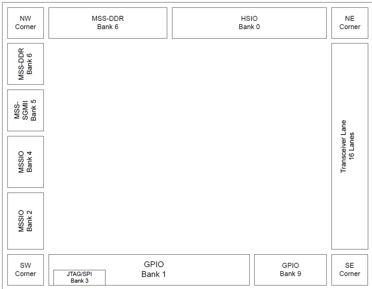
図 3-4. PolarFire SoC FPGA MPFS250-FCG1152 の I/O バンク 配置
