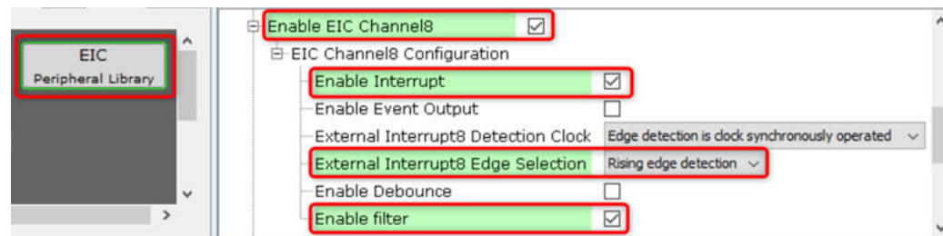
図1-13. MPLAB Code Configurator - EIC PLIBのチャンネル8の設定
