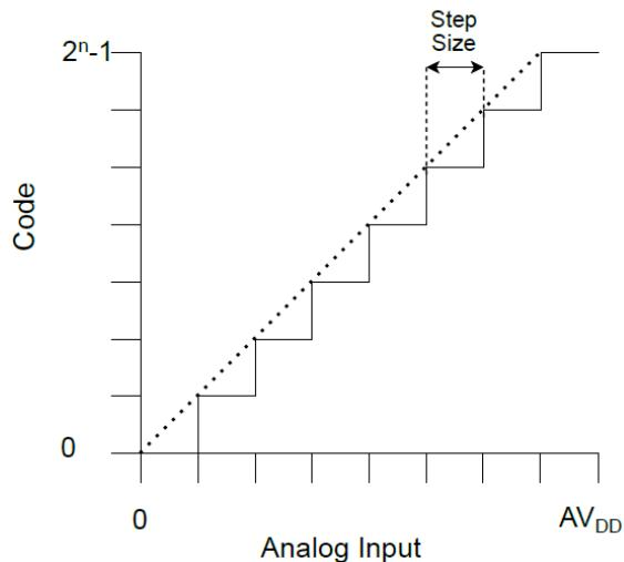
リニアランプ ヒストグラム法では、各出力コードに対応するビン(量子化区間)が使われます。この手法上、変換誤差に対応するため、上限の上と下限の下にもビンが用意されます。しかしこの2つのビンは特性評価ヒストグラムには使われません。また、下端のビンはオフセット誤差として表れる場合があります。ヒストグラムの例を**図1-2**に示します。各ビンのヒット数(変換結果がこのビン区間にに入った数)がカウントされ、理想的なヒット数と比較されます。各ビンのヒット数の比率を使って実際の伝達関数がプロットされます。全てのADC精度仕様値の単位はLSBです。
