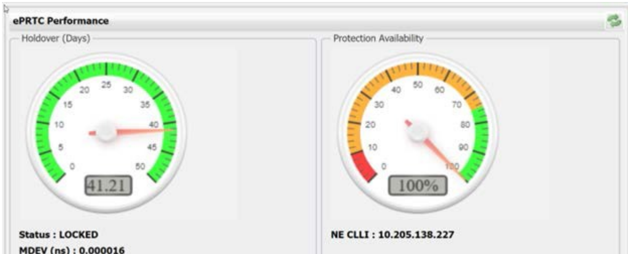
図 1-1. TimePictra 同期管理システムによる ePRTC ホールドオーバー性能監視画面
