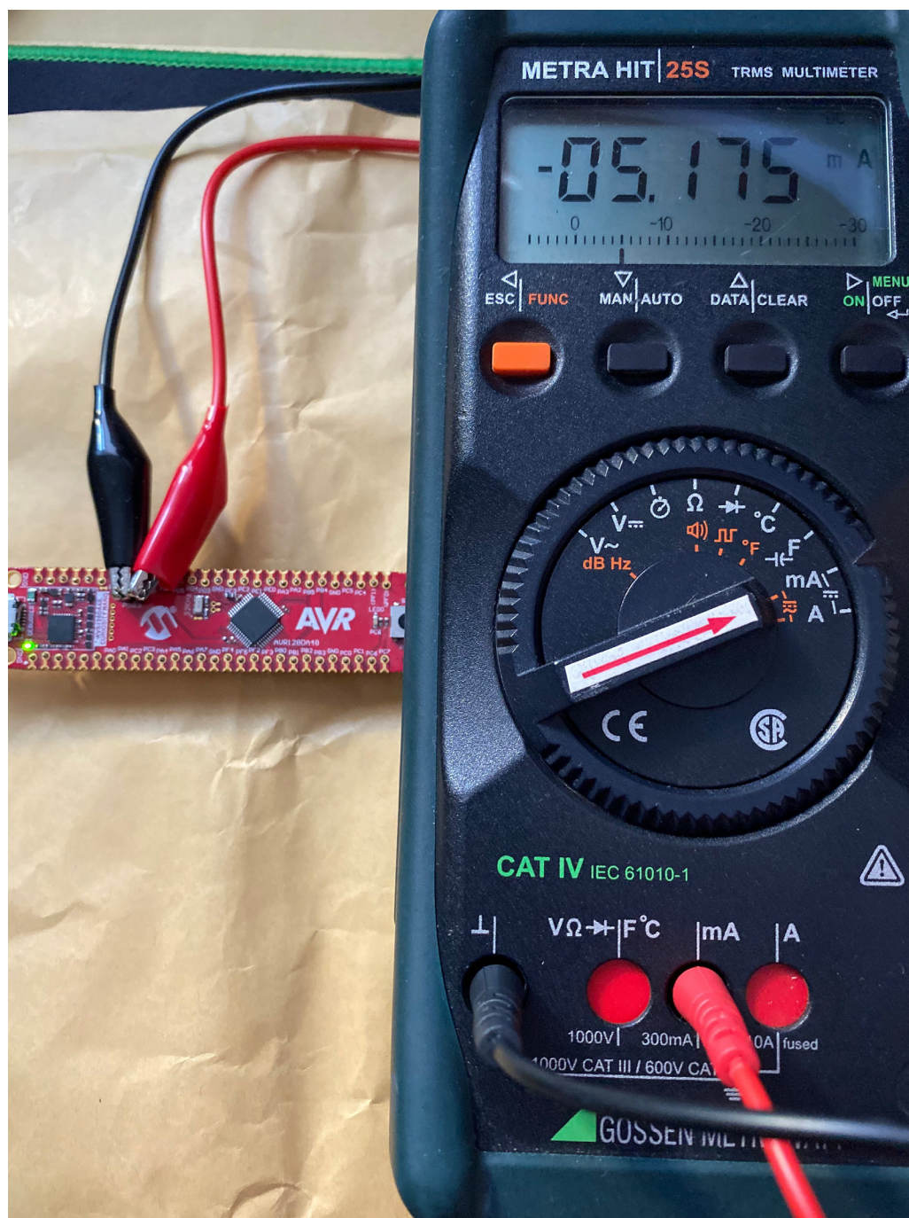
図3-1. マルチメータ セットアップによる電流計測
