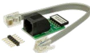
あるいは、アダプタボードを使う事で、MPLAB PICkit Basic は 6 ピンおよび 8 ピン ICSP インターフェイス向けに 8 ピン 50 mil Microchip Universal 接続を提供します。
