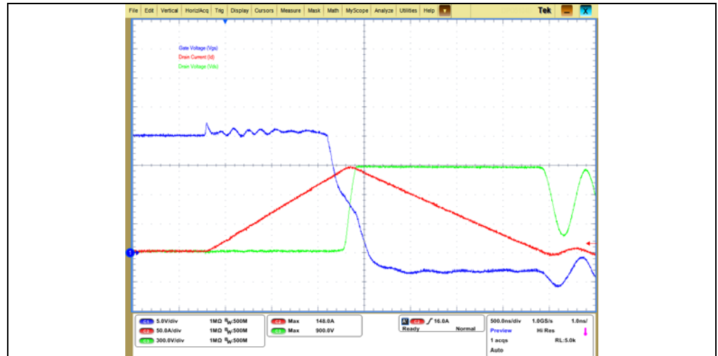
図 2-45: 高電圧補助 E ヒューズ バリエント C の短絡試験結果
