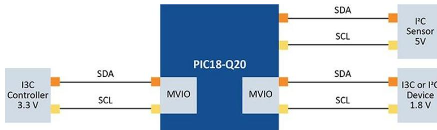
図 3: オンチップ レベルシフタ(MVIO)を使った複数電圧領域を示すバストポロジ
