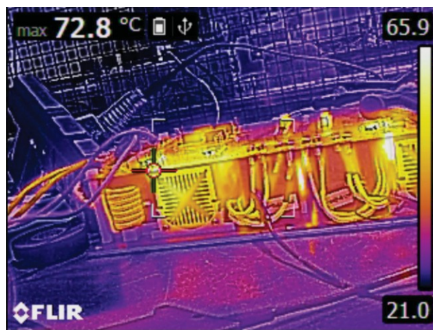
図 4-11. フルパワー動作時の評価ボード機器のサーモグラフィ画像
