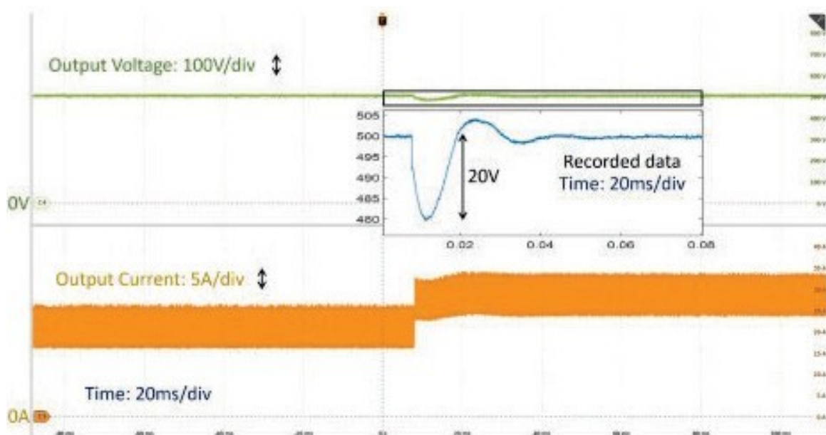
図 4-5. 負荷ステップ応答(11 kW→15 kW、出力電圧 = 500 V)
